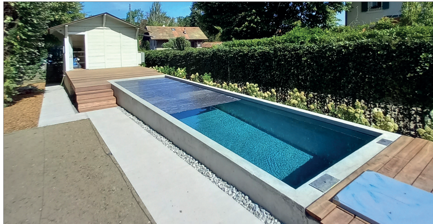
Des piscines que les couvertures thermiques suffisent largement à maintenir à une température agréable, sans apport extérieur d'énergie.
